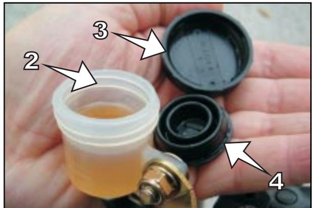
**IF THE BRAKE FLUID LEVEL FALLS BELOW THE MINIMUM VALUE, IT INDICATES A LEAKING IN THE BREAKING SYSTEM OR CONSUMPTION OF BRAKE PADS BEYOND THE ACCEPTABLE LIMIT.**
